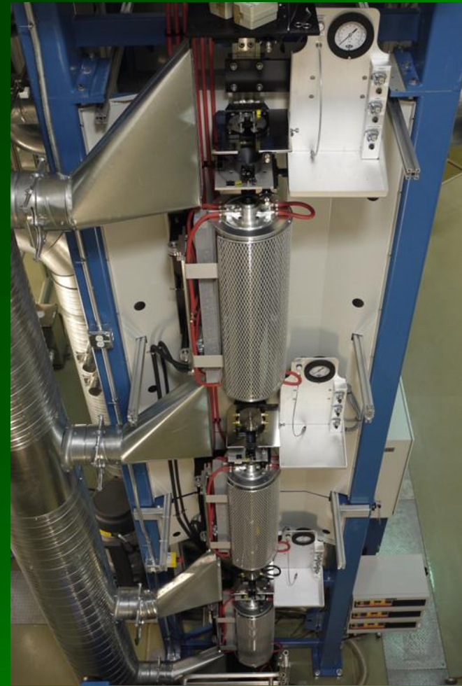
用于热处理涂覆层的拉丝塔
